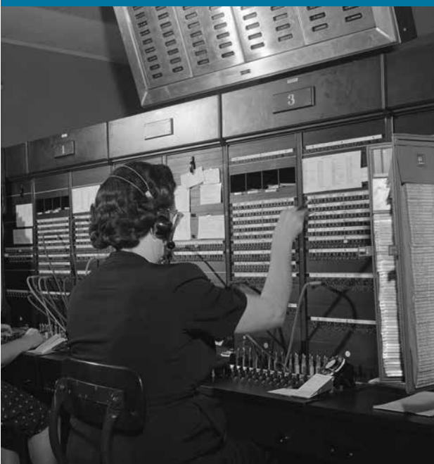
Fernsprechvermittlung, um 1925. Die Steckfelder von einst haben inzwischen billionenfach leistungsfähigere Halbleiterschaltungen ersetzt.
